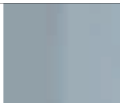
StoPox BB OS, standardní povrchová úprava bez obsahu silikonu, polovina plochy opatřena uzavíracím matným trans- parentním lakem StoPur DL 200
